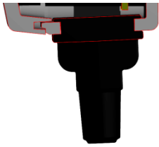
Abbildung 3: Korrekt eingesetzte Dichtungs- tülle
