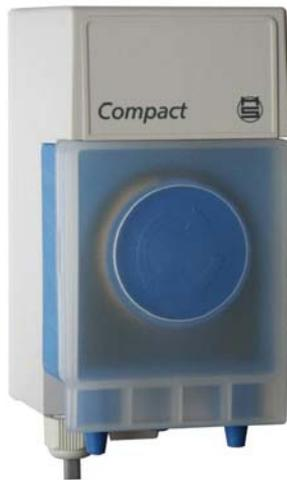
SAIER setzt mit den Geräten der **Compact-Serie** einen neuen Standard in Sachen Dosiertechnik. Die Förderleistung von 75 ml/min, die Gehäusebreite von 65 mm, die Größe des DC-Motors sowie zahlreiche Qualitätsbauelemente wie die doppelte Kugellagerung der Antriebswelle, die mikrocontrollergesteuerte Drehzahlregelung (GCL-Regelung), der gefederte Rotor und das flexible Schlauchhaltersystem 9911 charakterisieren die Leistung der **Compact-Klasse**.
