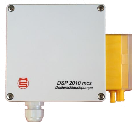
Eine präzise Rotordrehzahlregelung (GCL-Technologie) sorgt beim DSP 2010 mcs zusammen mit einem leistungsfähigen DC-Motor für sehr genaue Dosierung und für eine hohe Lebensdauer.
